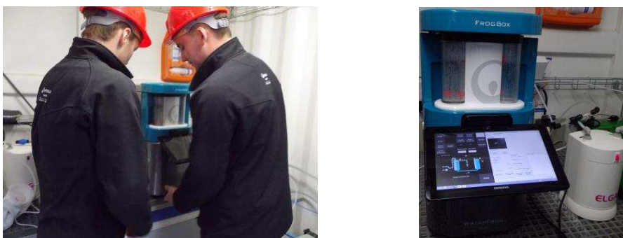
Figure 2. Installation de la Frogbox pour l'évaluation de la qualité de l'effluent du pilote Actiflo®Carb.
